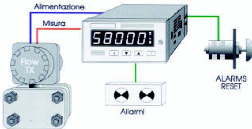
*Il DPL incorpora una alimentazione ausiliaria 24 V isolata che consente di alimentare direttamente trasmettitori a 2 o 4 fili semplificando il cablaggio e riducendo i costi di impianto. Inoltre, lo strumento è fornito di due allarmi indipendenti che possono essere programmati come allarmi a riarmo automatico o manuale. Il riarmo manuale può essere eseguito tramite la tastiera dello strumento oppure tramite contatto esterno.*
