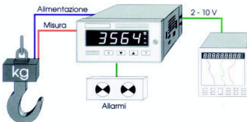
*La disponibilità della ritrasmissione del valore visualizzato (con isolamento galvanico) consente di risolvere in maniera economica svariati problemi di impianto come, ad esempio, la registrazione dell'andamento delle misure o la visualizzazione in loco ed in sala controllo del valore misurato. Lampeggia quando la condizione di allarme non è più presente ma l'allarme non è ancora stato riarmato (\*).*
